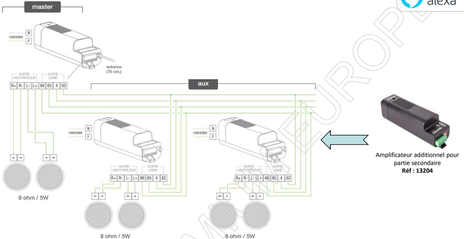
Amplificateur additionnel pour partie secondaire
