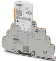
Protection antisurtension, consistant en une fiche de protection antisurtension et un élément de base, avec indicateur d'état intégré et sectionnement par couteau pour un circuit de signal bifilaire sans potentiel de terre avec une intensité nominale élevée.
