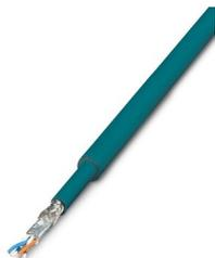
Câble CAT5-SF/UTP (J-02YS(ST)C HP 2 x 2 x 24 AWG), câble d'installation lourd, 2 x 2 x 0,22 mm<sup>2</sup>, conducteur massif, blindé, gaine extérieure : 7,8 mm de diamètre, gaine intérieure : 5,75 mm ± 0,15 mm de diamètre, confectionné avec des connecteurs RJ45 des deux côtés, crossover ou line
