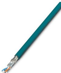
Câble CAT5-SF/UTP (J-LI02YS(ST)C H 2 x 2 x 26 AWG), câble léger pour installation souple, 2 x 2 x 0,14 mm<sup>2</sup>, conducteur souple, blindé, gaine extérieure : 5,75 mm ± 0,15 mm de diamètre, confectionné avec des connecteurs RJ45 des deux côtés, crossover ou line
