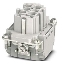
Élément de contact, nombre de pôles: 6+PE, taille: B6, nombre de raccordements par pôle: 1, Connecteur femelle, Raccordement Push-in, 500 V, 16 A, 0,14 mm<sup>2</sup> ... 2,5 mm<sup>2</sup>, application: Puissance
