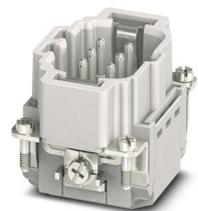
Élément de contact, nombre de pôles: 6+PE, taille: B6, nombre de raccordements par pôle: 1, Mâle, Raccordement Push-in, 500 V, 16 A, 0,14 mm<sup>2</sup> ... 2,5 mm<sup>2</sup>, application: Puissance
