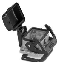
Embase B6, avec étrier longitudinal, matériau: Aluminium coulé sous pression, résistant à l'eau de mer, matériau du couvercle de protection: PC, hauteur: 30,5 mm, presse-étoupe: sans, capot de protection: oui, Standard, avec joint plat
