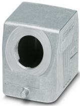
Capot passe-câble B6, pour étrier longitudinal, matériau: Aluminium coulé sous pression, résistant à l'eau de mer, nombre de sorties: 1, latérale, 1x M20, hauteur: 52 mm, presse-étoupe: sans, Standard
