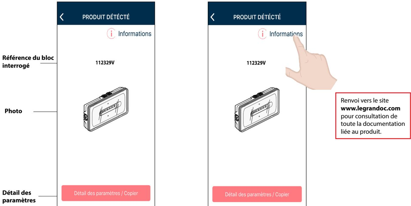
**Etape 2 :** Cliquer sur "DÉTAIL DES PARAMÈTRES" pour avoir accès à la liste complète des paramètres et à des informations complémentaires. Durant cette étape il faut maintenir la passerelle en direction du bloc interrogé, le chargement des paramètres est visualisable sur l'écran du téléphone.
