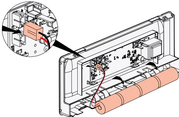
Après le changement des accumulateurs, remplacer l'étiquette de maintenance en y inscrivant la date de remise en service du bloc.
