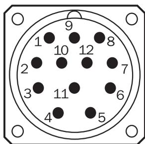
Vue connecteur d'appareil M23 sur le codeur
