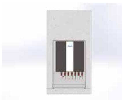
Montez le module d'appartement sur les raccords avec filetage M8 dans le boîtier d'encastrement puis connectez-le aux vannes à secteur. Fixez ensuite l'ensemble à l'aide de vis.
