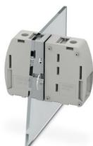
Bloc de jonction de traversée, type de raccordement: Raccordement vissé avec bague, Raccordement vissé avec bague, nombre de pôles: 1, courant de charge: 232 A, enfichage du conducteur vers le sens d'enfichage: 0 °, largeur: 25 mm
