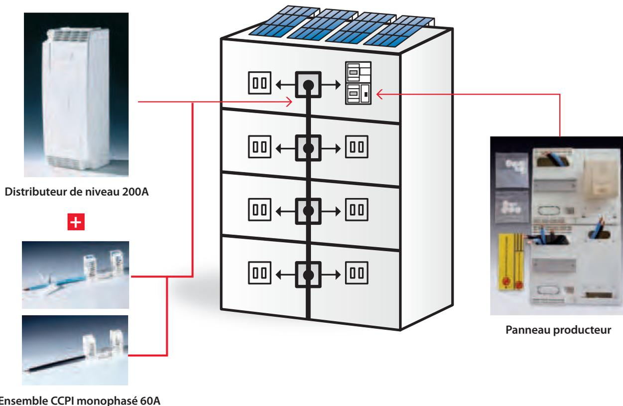
S'il n'y a pas d'emplacement de libre dans la colonne pour raccorder l'ensemble CCPI monophasé 60A, ajouter un distributeur de niveau supplémentaire.
