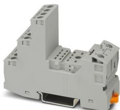
Embase de relais RIF-2, pour relais industriels avec 2 ou 4 contacts inverseurs, raccordement vissé, enfichabilité pour modules d'entrée/antiparasite, montage sur NS 35/7,5
