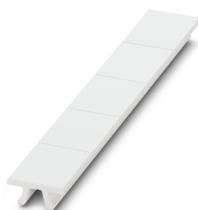
Ruban de repérage ZB, à commander : par bandes, blanc, impression selon les indications du client, type de montage: encliquetage dans la rainure de repérage élevée, pour bloc de jonction au pas de : 15,2 mm, surface utile: 10,5 x 15,1 mm, Nombre d'étiquettes: 5
