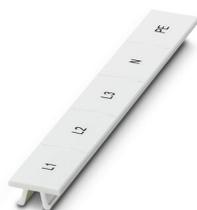
Ruban de repérage ZB, Rubans, blanc, repéré, impression longitudinale: L1, L2, L3, N, PE, type de montage: encliquetage, pour bloc de jonction au pas de : 16,3 mm, surface utile: 10,5 x 16,25 mm, Nombre d'étiquettes: 5
