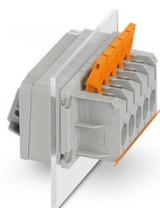
Bloc de jonction de traversée, type de raccordement: Raccordement Push-Lock, Raccordement à ressort Push-in, nombre de pôles: 4, courant de charge: 41 A, section: 2,5 mm<sup>2</sup> - 10 mm<sup>2</sup>, enfichage du conducteur vers le sens d'enfichage: 0 °, largeur: 64,4 mm
