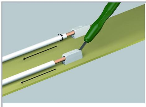
Déconnecter les conducteurs rigides avec l'outil de manipulation ou en tournant et en tirant
