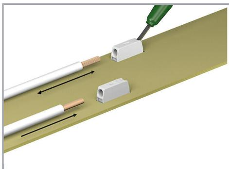
Outil de manipulation pour raccorder les conducteurs souples et déconnecter tous les conducteurs La connexion des câbles rigides se réalise par insertion directe.
