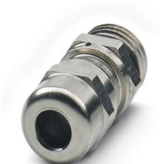
Presse-étoupe, matériau du raccordement vissé: Laiton, nickelé, diamètre extérieur du câble 6 mm ... 11 mm, blindage: non, filetage de raccordement: M20 x 1,5, coloris: argenté, avec éléments de compensation de pression et joint torique
