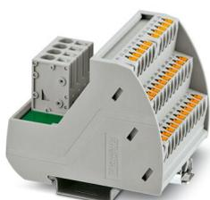
Module VARIOFACE, avec deux barres collectrices (P1, P2) destinées à la répartition du potentiel, montage sur profilé NS 35. Pas du module : 67,3 mm
