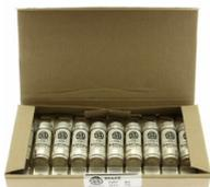
**Cartouche fusible, grande vitesse, 63 A, AC 690 V, DC 500 V, 200 kA, BS88, 18 x 96 mm, aR, BS, Entraxes de fixation 80 mm spéciaux, fusible thyristor**
