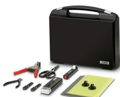
Jeu d'outils de polissage SC-RJ, pour fibre polymère, pour la confection du terrain des connecteurs SC-RJ (IP20/IP67) à raccordement autodénudant, avec outil de dégainage et de dénudage, pince coupante diagonale, ciseaux aramide, matériaux de polissage, microscope, 2 x connecteur SC-RJ IP20
