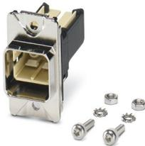
Cadre de montage SC-RJ, IP67, pour verrouillage Push-Pull, métallique, pour découpe de montage rectangulaire, avec joint, vis de fixation et prolongateur SC-RJ
