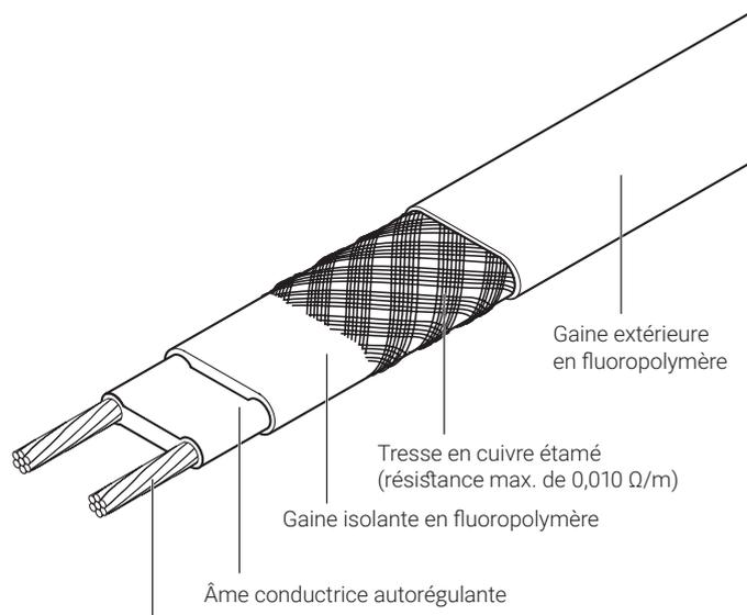
Conducteurs en cuivre nickelé de 1,4 mm<sup>2</sup> (10 et 15QTVR2-CT)
