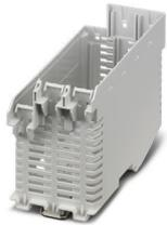
Boîtier électronique sur rail DIN, Partie inférieure du boîtier avec pied métallique de verrouillage, avec fentes d'aération, largeur: 56,88 mm, hauteur: 120,6 mm, profondeur: 82,85 mm, coloris: gris clair (7035), connexion transversale: Connecteur de bus sur rail DIN (en option), nombre de pôles connecteur transversal: 5 ou 8
