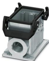
Embase en saillie D50, avec étrier transversal, matériau: Aluminium coulé sous pression, résistant à l'eau de mer, nombre de sorties: 2, latérale, 2x M25, hauteur: 82 mm, presse-étoupe: sans, Standard
