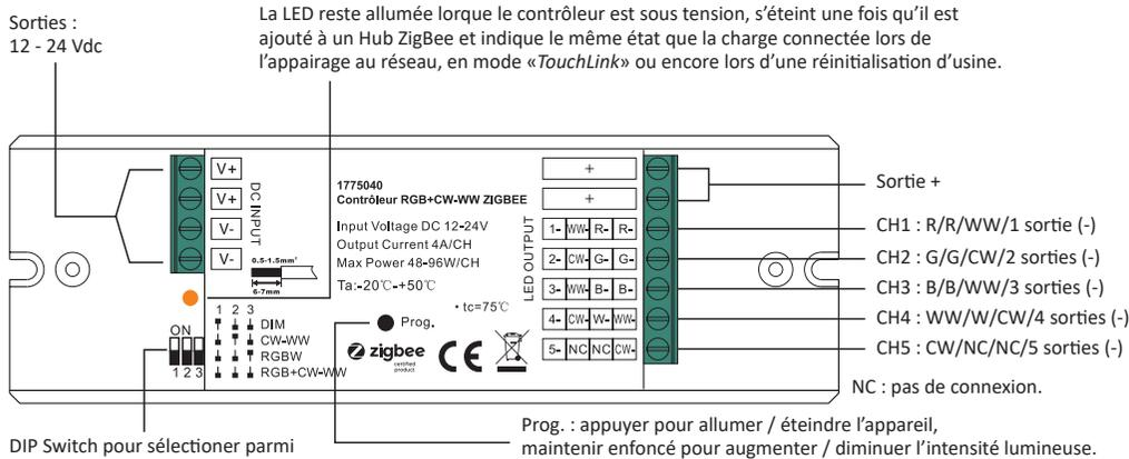
DIP Switch pour sélectionner parmi 4 modes : DIM, CW-WW, RGBW ou RGB + CW-WW.
