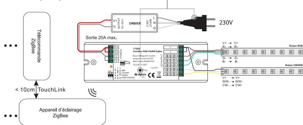
2. Configurer un autre appareil ou une autre télécommande en mode «Appairage au réseau ZigBee» et l'ajouter au réseau. Se reporter aux manuels des produits pour savoir comment s'y prendre.
