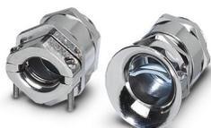
Raccordement vissé métallique avec bride de décharge de traction, longueur du filetage : 8 mm, plage d'étanchéité du câble : 18 - 27 mm, capacité de serrage : 19 - 30 mm, SW 40, raccordement vissé : M32
