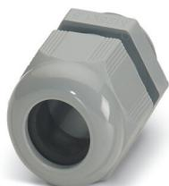
Presse-étoupe, matériau du raccordement vissé: PA, diamètre extérieur du câble 15 mm ... 21 mm, blindage: non, filetage de raccordement: M32 x 1,5, coloris: gris argent RAL 7001
