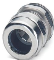
Presse-étoupe, matériau du raccordement vissé: Laiton, nickelé, diamètre extérieur du câble 14 mm ... 21 mm, blindage: oui, filetage de raccordement: M32 x 1,5, coloris: argenté, avec joint torique
