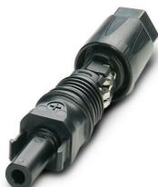
Connecteur, Famille d'articles: Sunclix, matériau du boîtier: PPE, coloris: noir, nombre de pôles: 1, section de fil min.: 2,5 mm<sup>2</sup>, section de fil max.: 6 mm<sup>2</sup>, tension de référence: 1100 V DC, courant de référence: 40 A, Type de raccordement: A ressort, Type de contact: Connecteur femelle, diamètre de câble min.: 5,5 mm, diamètre de câble max.: 8 mm. Produit successeur : 1386381
