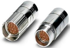
Connecteur prolongateur, droit, Verrouillage à vis, M23, nombre de pôles: 12, type de contact: Mâle, blindé: oui, indice de protection: IP67, plage de diamètre de câble: 5 mm ... 13,2 mm, nombre de pôles: 12, type de raccordement: Raccordement à sertir, série: RF, Produit de remplacement selon RoHS II sans exception 6c (Pb < 0,1 %) référence : 1242246
