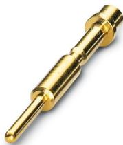
Contact à sertir, Mâle, tournés, Contact unique, diamètre de contact: 1 mm, zone de sertissage: 0,14 mm<sup>2</sup> ... 0,5 mm<sup>2</sup>, Produit de remplacement selon RoHS II sans exception 6c (Pb < 0,1 %) référence : 1241921
