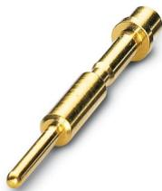
Contact à sertir, Mâle, tournés, Contact unique, diamètre de contact: 1 mm, zone de sertissage: 0,06 mm<sup>2</sup> ... 0,25 mm<sup>2</sup>, Produit de remplacement selon RoHS II sans exception 6c (Pb < 0,1 %) référence : 1241921
