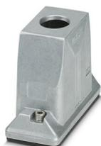
Capot passe-câble HEAVYCONNEC ADVANCE, B16, avec verrouillage à vis (six pans creux) en acier inoxydable, aluminium résistant à l'eau de mer, hauteur 93,7 mm, avec filetage, 1x M40 sortie de câble droite, sans surface ; joint conducteur (propriétés CEM)
