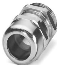
Presse-étoupe, matériau du raccordement vissé: Laiton, nickelé, diamètre extérieur du câble 19 mm ... 28 mm, blindage: non, filetage de raccordement: M40 x 1,5, coloris: argenté, avec joint torique
