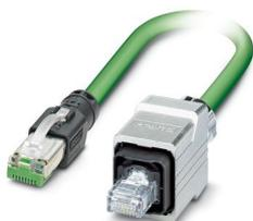
Câble PROFINET préconfectionné, CAT 5e, blindé, quarte en étoile, AWG 22 flexible (7 fils), RAL 6018 (jaune-vert), connecteur mâle RJ45/IP67 boîtier métallique Push-Pull sur connecteur mâle RJ45/IP20, Line, longueur : 5 m
