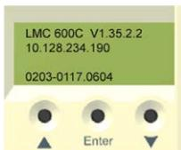
Outre les voyants, l'écran à cristaux liquides (LCD) de quatre lignes fournit d'autres informations sur l'état de fonctionnement du contrôleur.
