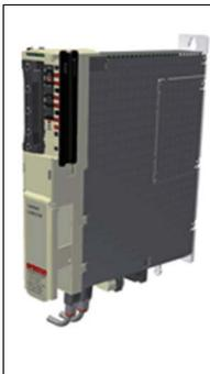
Le Lexium 62 Connection Module alimente les Lexium 62 ILMs en tension alternative depuis le bus DC via un câble hybride ou un câble d'alimentation (câblage en boucle de chaînage). Le module de connexion Lexium 62 (Lexium 62 connection module) sert d'interface Sercos et offre la fonction Inverter Enable.
