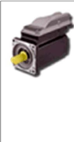
Le Lexium 62 ILM est un produit novateur qui combine un moteur, un étage de puissance et un servo-contrôleur logique pour un axe dans un boîtier compact. Ce format réduit avec contrôleur intégré en fait une solution idéale pour les configurations en périphérie. Le Lexium 62 ILM contient un codeur monotour ou multitour et s'autoconfigure grâce à sa plaque signalétique électronique.
