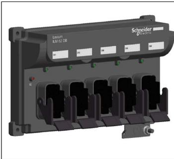
Le Lexium 62 distribution box assure la liaison entre le Lexium 62 Connection Module et le Lexium 62 ILM. Selon le nombre de variateurs, il est possible de raccorder 1 à 4 Lexium 62 ILMs ou lignes de boucle de chaînage. Au-delà de 4 variateurs, le système peut être étendu facilement avec un Lexium 62 distribution box ou plusieurs.
