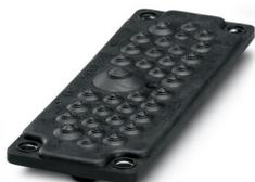
Plaques passe-câble, nombre de conducteurs: 35, diamètre extérieur du câble: 2x 6 mm ... 10 mm, 14x 8 mm ... 12 mm, 16x 10 mm ... 14 mm, 2x 12 mm ... 18 mm, 1x 17 mm ... 32 mm, matériau: Tôle d'acier galvanisé (matériel intérieur), matériau: TPE-SEBS (matériel extérieur), coloris: noir, longueur: 222 mm, largeur: 92 mm, hauteur: 17,6 mm
