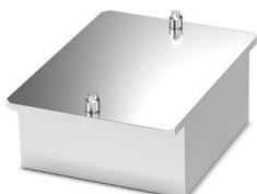
Élément d'expansion thermique pour série de boîtiers: UCS, version: Élément d'expansion thermique, matériau: Aluminium, anodisée, gamme d'articles: UCS, largeur: 67 mm, La fixation de l'élément d'expansion thermique sur le dissipateur thermique nécessite un traitement supplémentaire.
