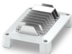
Demi-coque de boîtier avec dissipateur thermique et élément d'extension thermique UCS HSP 22-25 AL pour la réalisation d'un boîtier UCS de dimensions 125 x 87 mm ; matériau polycarbonate, aluminium ; couleur gris clair semblable à RAL 7035
