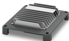
Demi-coque de boîtier avec dissipateur thermique et élément d'extension thermique UCS HSP 22-25 AL pour la réalisation d'un boîtier UCS de dimensions 145 x 125 mm ; matériau polycarbonate, aluminium ; couleur noire semblable à RAL 9005
