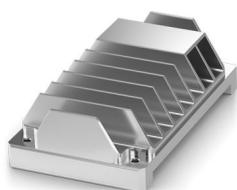
Dissipateur de chaleur pour série de boîtiers: UCS, version: Demi-coque, matériau: Aluminium, anodisée, gamme d'articles: UCS, largeur: 56,8 mm, hauteur: 94,8 mm, La demi-coque de boîtier nécessite un fraisage.
