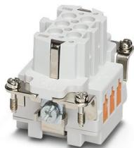
Élément de contact, taille: B6, Raccordement QUICKON, 500 V, 16 A, 0,34 mm<sup>2</sup> ... 2,5 mm<sup>2</sup>
