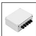
S.2437 ALIMENTATION ELECTRONIQUE MULTI-POWER 230V/350mA-1050mA DALI DIMMABLE, 1-10V, PUSH DIM IN BOX IP55 60W 230V/350mA-1050mA Puissance maximale installable: 60W Dimensions 260mmx260mmx100mm IP55 CLASSE II SELV 120V L'UTILISATION DU DÉCHARGEUR À SURTENSION S.2499 EST RECOMMANDÉE POUR CHAQUE BALLAST ÉLECTRONIQUE QUI DOIT ÊTRE INSTALLÉ À UNE DISTANCE MAXIMALE DE 10m DE CELUI-CI.
