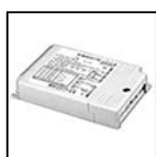
S.2413 ALIMENTATION ELECTRONIQUE DALI / 1-10V / PUSH MULTI- POWER 230V/250mA-700mA IP20 230V/250mA-700mA Puissance maximale installable: @250mA 28W, @700mA 60W. Dimensions 124mmx79mmx22mm IP20 L'UTILISATION DU DÉCHARGEUR À SURTENSION S.2499 EST RECOMMANDÉE POUR CHAQUE BALLAST ÉLECTRONIQUE QUI DOIT ÊTRE INSTALLÉ À UNE DISTANCE MAXIMALE DE 10m DE CELUI-CI.
