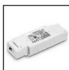
S.2417 ALIMENTATION ELECTRONIQUE DALI2 / PUSH MULTI-POWER 230V/200mA-550mA IP20 230V/200mA-550mA Puissance maximale installable: @200mA 9W, ..., @550mA 19,8W. Dimensions 116mmx41mmx22mm IP20 L'UTILISATION DU DÉCHARGEUR À SURTENSION S.2499 EST RECOMMANDÉE POUR CHAQUE BALLAST ÉLECTRONIQUE QUI DOIT ÊTRE INSTALLÉ À UNE DISTANCE MAXIMALE DE 10m DE CELUI-CI.
