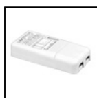
S.2412 ALIMENTATION ELECTRONIQUE 1-10V / PUSH MULTI-POWER 230V/250mA-900mA IP20 230V/250mA-900mA Puissance maximale installable: @250mA 13W, @900mA 20W. Dimensions 136mmx42mmx24mm IP20 L'UTILISATION DU DÉCHARGEUR À SURTENSION S.2499 EST RECOMMANDÉE POUR CHAQUE BALLAST ÉLECTRONIQUE QUI DOIT ÊTRE INSTALLÉ À UNE DISTANCE MAXIMALE DE 10m DE CELUI-CI.
