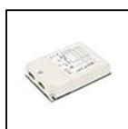
S.2431 ALIMENTATION ELECTRONIQUE MULTI-POWER 230V/350mA-1050mA 39W IP20 Puissance maximale installable: 39W Dimensions 130mmx67mmx21mm IP20 CLASSE II SELV L'UTILISATION DU DÉCHARGEUR À SURTENSION S.2499 EST RECOMMANDÉE POUR CHAQUE BALLAST ÉLECTRONIQUE QUI DOIT ÊTRE INSTALLÉ À UNE DISTANCE MAXIMALE DE 10m DE CELUI-CI.
