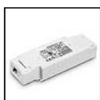
S.2418 ALIMENTATION ELECTRONIQUE DALI2 / PUSH MULTI-POWER 230V/700mA-1050mA IP20 230V/700mA-1050mA Puissance maximale installable: @700mA 28W, ..., @1050mA 34,7W. Dimensions 136mmx42mmx24mm IP20 L'UTILISATION DU DÉCHARGEUR À SURTENSION S.2499 EST RECOMMANDÉE POUR CHAQUE BALLAST ÉLECTRONIQUE QUI DOIT ÊTRE INSTALLÉ À UNE DISTANCE MAXIMALE DE 10m DE CELUI-CI.
