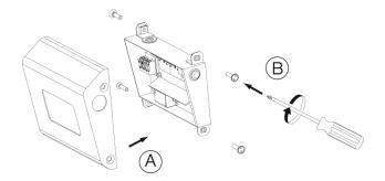
Refermer l'ensemble cadre + diffuseur à l'aide d'un tournevis adapté et de l'insert anti-vandale 98000004.
