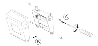
Déposer l'ensemble cadre + diffuseur à l'aide d'un tournevis adapté et de l'insert anti-vandale 98000004.
