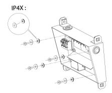
Pour la fixation du luminaire, utiliser des vis de diamètre 5mm à tête plate et des chevilles adaptées au type de paroi pour avoir une résistance optimale à l'arrachement. Les vis et chevilles ne sont pas fournies avec le luminaire.
