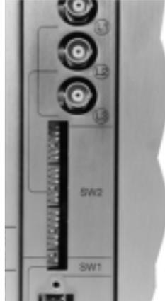
Positionner les micro-interrupteurs SW1 et SW2 de la carte EA (emplacement 2) selon le tableau ci-contre. Ils doivent être positionnés selon :
