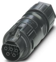
Connecteur prolongateur, Famille d'articles: PRC 35, type: Déverrouillage avec un outil ou à la main (voir accessoires), matériau du boîtier: PPE, coloris: noir, nombre de pôles: 5, section de fil min.: 1,5 mm<sup>2</sup>, section de fil max.: 6 mm<sup>2</sup>, tension de référence: 690 V AC, courant de référence: 35 A, Type de raccordement: Raccordement vissé, Type de contact: Connecteur femelle, diamètre de câble min.: 8 mm, diamètre de câble max.: 21 mm. Variante pour le déverrouillage manuel
