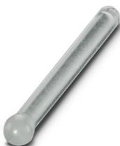
Fibre optique verticale 4 mm, transparente, avec tête bombée, sphérique de 5,2 mm, montage pour des épaisseurs de paroi à partir de 1 mm, en polycarbonate (UL 94-V0), longueur utile de 45 mm, étanche à l'eau, IP68 (EN 50529)
