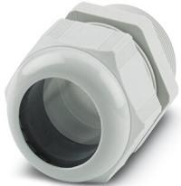
Presse-étoupe, matériau du raccordement vissé: PA, diamètre extérieur du câble 30 mm ... 36 mm, blindage: non, filetage de raccordement: M50 x 1,5, coloris: gris clair RAL 7035
