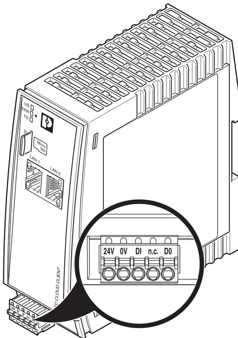
Raccordement de la tension d'alimentation
