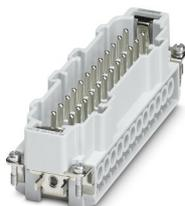
Élément de contact, nombre de pôles: 24+PE, taille: B24, nombre de raccordements par pôle: 1, Mâle, Raccordement vissé, 500 V, 16 A, 0,5 mm<sup>2</sup> ... 2,5 mm<sup>2</sup>, application: Puissance
