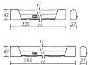
Corps aluminium/Vasque polycarbonate. Interrupteur. Boîte de connexion centrale située à l'arrière de la réglette. Pièce de fixation réglable à l'arrière.
