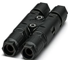
Répartiteur en H, Raccordement QUICKON, nombre de pôles: 2+PE, 690 V, 17,5 A, noir, avec quatre écrous QUICKON, diamètre extérieur du câble: 5 mm .. 9,5 mm, avec un boulon de fermeture
