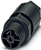
Traversée de paroi, Raccordement QUICKON, nombre de pôles: 2+PE, Mâle, 690 V, 15 A, noir, avec écrou QUICKON, diamètre extérieur du câble: 5 mm ... 9,5 mm, filetage de montage: M20, Raccordement par clips (pour clips selon DIN 46247-2), 1,5 mm<sup>2</sup>
