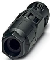
Prolongateur de câble, Raccordement QUICKON, nombre de pôles: 2+PE, 690 V, 17,5 A, noir, avec un écrou QUICKON, diamètre extérieur du câble: 5 mm ... 9,5 mm, Connecteur QUICKON
