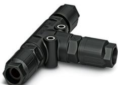
Répartiteur en T, Raccordement QUICKON, nombre de pôles: 2+PE, 690 V, 17,5 A, noir, avec 3 écrous QUICKON, diamètre extérieur du câble: 5 mm ... 9,5 mm
