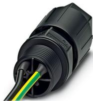
Traversée de paroi, Raccordement QUICKON, nombre de pôles: 2+PE, Mâle, 690 V, 17,5 A, noir, avec écrou QUICKON, diamètre extérieur du câble: 5 mm ... 9,5 mm, filetage de montage: M20, Fils individuels, 1,5 mm<sup>2</sup>, longueur du câble: 1 m
