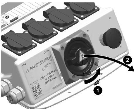
Ouvrir la trappe en tournant  $\frac{1}{8}$  de tour ( $45^\circ$ ) et la dégager du coffret .
