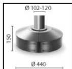
S.2809 CACHE-EMBASE Pour poteaux scellés ou enterrés. Fonte d'aluminium injecté peint. Diamètre 102mm ou 120mm. ADAPTATEUR SUR DEMANDE pour poteaux cylindriques diam. 60mm ou diam. 76mm
