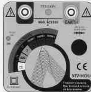
Avant toute mesure il est impératif de s'assurer que le circuit à contrôler est HORS tension. Mettre le commutateur sur la position 500V. Pour effectuer la mesure d'isolement, branchez les cordons de test appuyez sur le bouton TEST. Lire la valeur de la résistance d'isolement sur l'échelle appropriée. Relâchez le bouton TEST et laissez quelques secondes les cordons sur le dispositif afin d'assurer la décharge des circuits.
