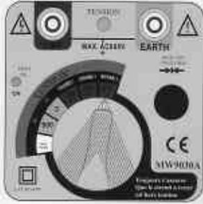
Avant toute mesure il est impératif de s'assurer que le circuit à contrôler est HORS tension. Mettre le commutateur sur la position 1000V. Pour effectuer la mesure d'isolement, branchez les cordons de test appuyez sur le bouton TEST. Lire la valeur de la résistance d'isolement sur l'échelle appropriée. Relâchez le bouton TEST et laissez quelques secondes les cordons sur le dispositif afin d'assurer la décharge des circuits.
