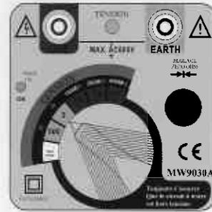
Avant toute mesure il est impératif de s'assurer que le circuit à contrôler est HORS tension. Mettre le commutateur sur la position 3 ohms. Branchez les cordons de test, réalisez un court-circuit et régler le zéro à l'aide du potentiomètre. Branchez les cordons de mesure sur le dispositif et appuyez sur TEST. Lire la mesure sur l'échelle 3 ohms du galvanomètre.
