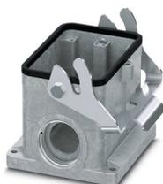
Embase en saillie B48, avec étrier longitudinal, matériau: Aluminium coulé sous pression, résistant à l'eau de mer, nombre de sorties: 2, latérale, 2x M32, hauteur: 99 mm, presse-étoupe: sans, Standard
