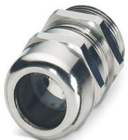
Presse-étoupe, matériau du raccordement vissé: Laiton, nickelé, diamètre extérieur du câble 10 mm ... 14 mm, blindage: oui, filetage de raccordement: Pg16, coloris: argenté, avec joint torique
