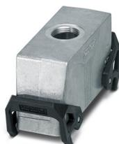
Capot passe-câble B24, avec étrier transversal, matériau: Aluminium coulé sous pression, résistant à l'eau de mer, nombre de sorties: 1, droit, 1x Pg16, hauteur: 60 mm, presse-étoupe: sans, Standard
