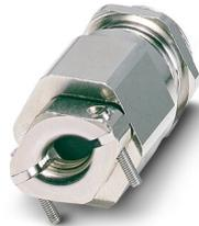
Presse-étoupe, matériau du raccordement vissé: Laiton, nickelé, diamètre extérieur du câble 16 mm ... 28 mm, blindage: non, filetage de raccordement: M40 x 1,5, coloris: argenté, avec dispositif anti-traction externe, avec joint torique
