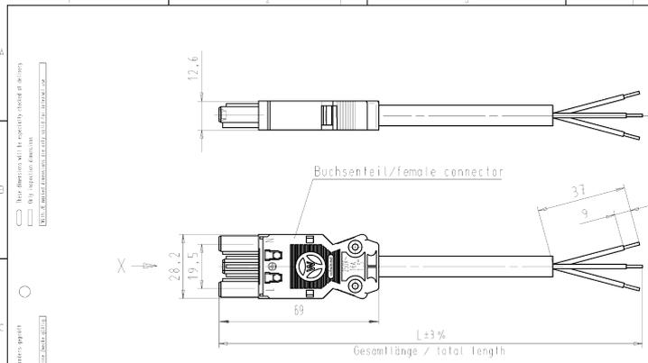
Kabel/cable: H05Z1Z1-F3G1,5 halogenfrei/halogen-free
