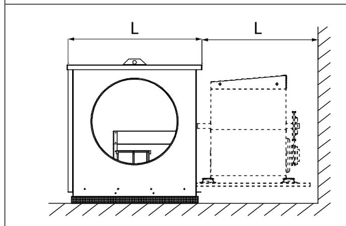
Côté transmission, prévoir une distance L minimum égale à la largeur du caisson
