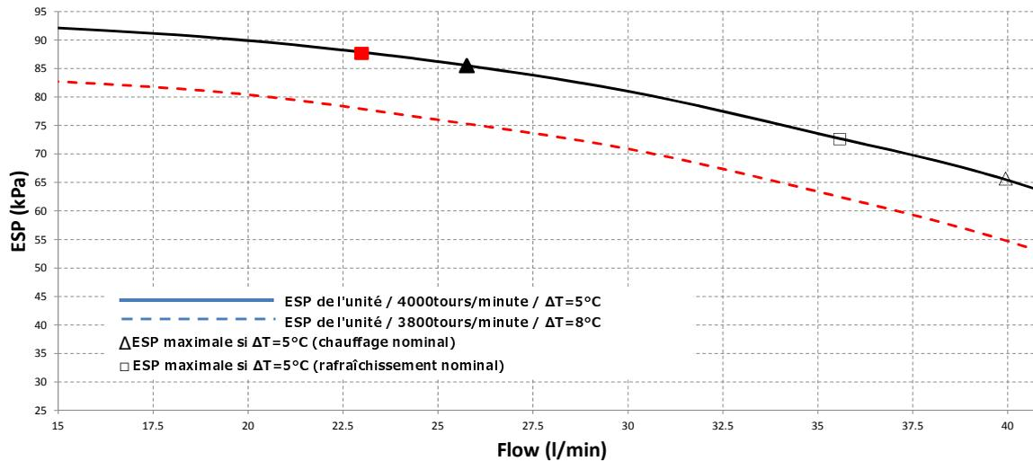
ESP: pression statique extérieure (External Static Pressure)
