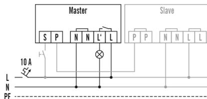
Raccordement maître/esclave avec commande optionnelle par poussoir. Un appareil maître peut être raccordé à 10 appareils esclaves au maximum.
