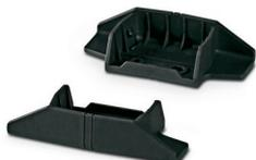
Socle pour la mise en place du boîtier UCS, hauteur : 47 mm, matériau : polyamide, couleur : noir, similaire à RAL 9005, possibilité de fixation murale intégrée, encliqueté dans les trous de vis du boîtier
