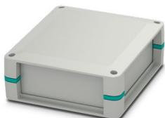
Boîtier complet pour circuit imprimé, fixé au niveau des inserts des montants d'angle , inclut des demi-coques de boîtier, des parois fermées, des inserts de montants d'angle avec support de fixation pour circuit imprimé, des vis pour boîtier et fixation du circuit imprimé , boîtier de couleur gris clair avec inserts de montants d'angle bleu turquoise
