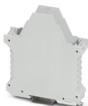
Boîtier électronique sur rail DIN, Partie inférieure du boîtier avec pied métallique de verrouillage, avec contact FE, design élancé, sans fente d'aération, largeur: 22,6 mm, hauteur: 99 mm, profondeur: 107,3 mm, coloris: gris clair (7035), connexion transversale: sans connecteur de bus, nombre de pôles connecteur transversal: sans objet
