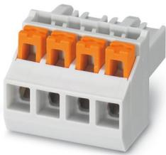
Connecteur mâle pour C.I., section nominale: 2,5 mm<sup>2</sup>, coloris: gris, intensité nominale: 16 A, tension de référence (III/2): 300 V, type de contact: Connecteur femelle, nombre de rangées: 1, nombre de pôles: 4, gamme d'articles: PSPT 2,5/..-ST, pas: 5 mm, type de raccordement: Raccordement à ressort Push-in, sens d'enfichage conducteur/circuit imprimé: 0 °, clip de verrouillage: - Clip de verrouillage, verrouillage: sans, type de fixation: sans
