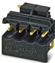
Embase de circuit imprimé, coloris: noir, surface des contacts: Or, type de contact: Mâle, nombre de pôles: 4, gamme d'articles: MSTBO 2,5/..-G1L THR Au, pas: 5 mm, montage: Soudage THR, plan des broches: Brochage linéaire, longueur de broche [P]: 2,5 mm, nombre de picots par potentiel: 1, système débrosable: COMBICON MSTB 2,5, type de conditionnement: Sangle en largeur de 44 mm, Article avec sortie de broche latérale
