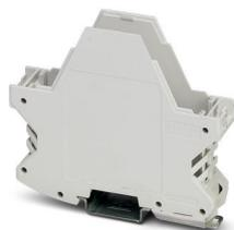
Boîtier électronique sur rail DIN, Partie inférieure du boîtier avec pied métallique de verrouillage, design plat, avec fentes d'aération, largeur: 22,6 mm, hauteur: 99 mm, profondeur: 84,8 mm, coloris: gris clair (7035), connexion transversale: Connecteur de bus sur rail DIN (en option), nombre de pôles connecteur transversal: 5
