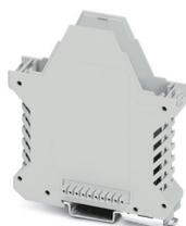
Boîtier électronique sur rail DIN, Partie inférieure du boîtier avec pied métallique de verrouillage, design élancé, avec fentes d'aération, largeur: 22,6 mm, hauteur: 99 mm, profondeur: 107,3 mm, coloris: gris clair (7035), connexion transversale: connecteur de bus intégré, nombre de pôles connecteur transversal: 10, Connecteur de bus : 10 contacts parallèles
