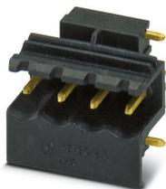
Embase de circuit imprimé, coloris: noir, surface des contacts: Or, type de contact: Mâle, nombre de pôles: 4, gamme d'articles: MSTBO 2,5/..-G1R THR Au, pas: 5 mm, montage: Soudage THR, plan des broches: Brochage linéaire, longueur de broche [P]: 2,5 mm, nombre de picots par potentiel: 1, système débrosable: COMBICON MSTB 2,5, type de conditionnement: Sangle en largeur de 44 mm, Article avec sortie de broche latérale droite
