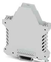
Boîtier électronique sur rail DIN, Partie inférieure du boîtier avec pied métallique de verrouillage, avec contact FE, design élancé, avec fentes d'aération, largeur: 22,6 mm, hauteur: 99 mm, profondeur: 107,3 mm, coloris: gris clair (7035), connexion transversale: connecteur de bus intégré, nombre de pôles connecteur transversal: 10, Connecteur de bus : 10 contacts parallèles
