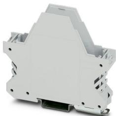
Boîtier électronique sur rail DIN, Partie inférieure du boîtier avec pied métallique de verrouillage et contact FE, design plat, avec fentes d'aération, largeur: 22,6 mm, hauteur: 99 mm, profondeur: 84,8 mm, coloris: gris clair (7035), connexion transversale: sans connecteur de bus, nombre de pôles connecteur transversal: sans objet
