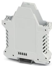
Boîtier électronique sur rail DIN, Partie inférieure du boîtier avec pied métallique de verrouillage, avec contact FE, design élancé, avec fentes d'aération, largeur: 22,6 mm, hauteur: 99 mm, profondeur: 107,3 mm, coloris: gris clair (7035), connexion transversale: connecteur de bus intégré, nombre de pôles connecteur transversal: 5, Connecteur de bus : 5 contacts parallèles
