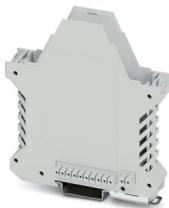
Boîtier électronique sur rail DIN, Partie inférieure du boîtier avec pied métallique de verrouillage, avec contact FE, design élancé, avec fentes d'aération, largeur: 22,6 mm, hauteur: 99 mm, profondeur: 107,3 mm, coloris: gris clair (7035), connexion transversale: connecteur de bus intégré, nombre de pôles connecteur transversal: 10+2, Connecteur de bus : 10 contacts parallèles, 2 contacts série
