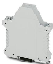
Boîtier électronique sur rail DIN, Partie inférieure du boîtier avec pied métallique de verrouillage, design élancé, sans fente d'aération, largeur: 22,6 mm, hauteur: 99 mm, profondeur: 107,3 mm, coloris: gris clair (7035), connexion transversale: sans connecteur de bus, nombre de pôles connecteur transversal: sans objet
