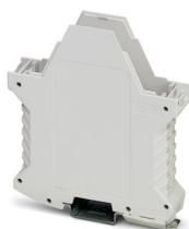
Boîtier électronique sur rail DIN, Partie inférieure du boîtier avec pied métallique de verrouillage, avec contact FE, design élancé, avec fentes d'aération, largeur: 22,6 mm, hauteur: 99 mm, profondeur: 107,3 mm, coloris: gris clair (7035), connexion transversale: Connecteur de bus sur rail DIN (en option), nombre de pôles connecteur transversal: 5
