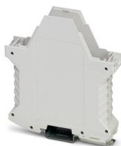
Boîtier électronique sur rail DIN, Partie inférieure du boîtier avec pied métallique de verrouillage, design élancé, sans fente d'aération, largeur: 22,6 mm, hauteur: 99 mm, profondeur: 107,3 mm, coloris: gris clair (7035), connexion transversale: Connecteur de bus sur rail DIN (en option), nombre de pôles connecteur transversal: 5
